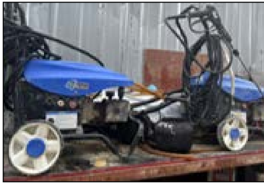
รูปที่ 2.1-4 อุปกรณ์ฉีดล้างล้อรถ
